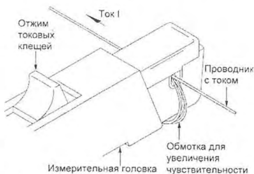
Рис. 5.18. Измерительная головка пробника Tektronix TCP202
