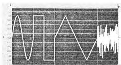
Рис. 6.31. Сложный сигнал в виде отрезков (по одному периоду) синусоиды, меандра, треугольного импульса и шума
