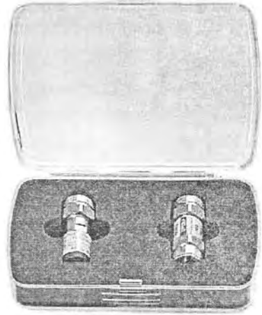
Рис. 5.38. Высокочастотные калиброванные коаксиальные аттенюаторы фирмы Agilent Technologies в упаковочном ящике
