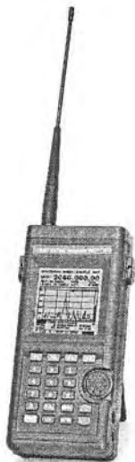
Рис. 3.7. Внешний вид анализатора напряженности электромагнитного поля АКТАКОМ АКС-1201
