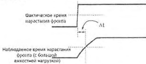
Рис. 4.7. Искажение импульсов вследствие конечной входной емкости канала
