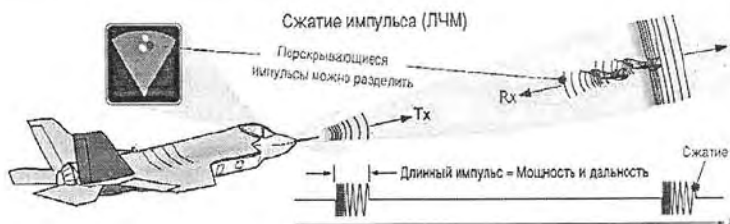
Рис. 2.53. Иллюстрация радиолокации с применением линейной частотной модуляции
