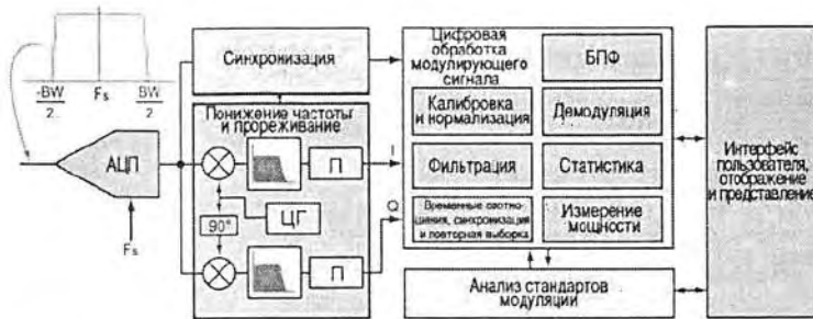
Рис. 2.5. Функциональная схема цифрового преобразования анализаторов реального спектра
