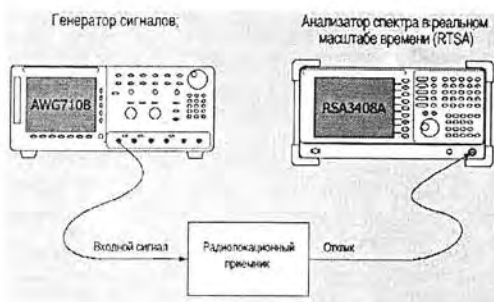
Рис. 2.50. Схема испытания приемника радиолокационной станции
