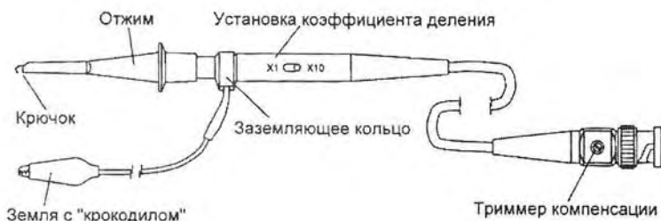
Рис. 5.2. Конструкция стандартного пассивного пробника HP-9250 на основе частотно-компенсированного делителя
