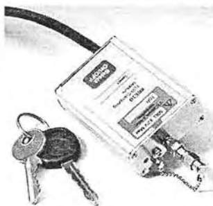
Рис. 5.45. Часть модуля TDR для подключения к источнику сигнала
