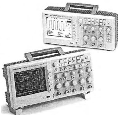
Рис. 3.17. Новейшие бюджетные осциллографы TDS1000B/2000B корпорации Tektronix
