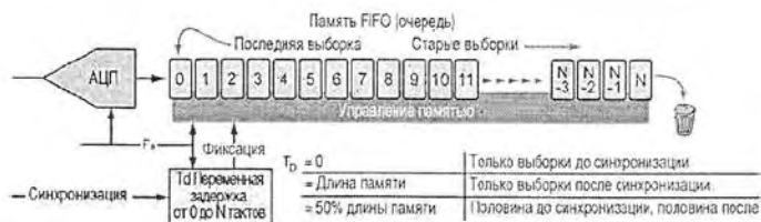
Рис. 2.12. Функциональная схема синхронизации в системах с цифровой регистрацией сигналов
