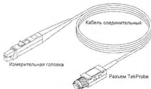
Рис. 5.17. Токовый пробник Tektronix TCP202 с интерфейсом TekProbe
