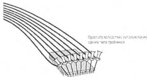
Рис. 4.9. Подключение к микросхеме одиночных пробников с общей землей
