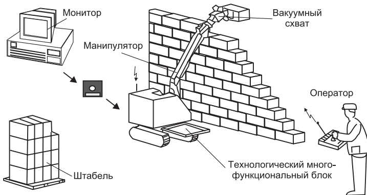
Рис. 7.23. Автоматическая кладка камня
