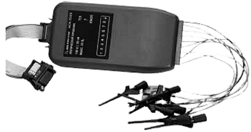
Рис. 3.24. Блок логического анализатора для осциллографа АСК-2023
