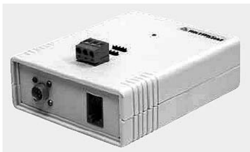
Рис. 4.44. Внешний вид приставки АСС-4211 для снятия ВАХ маломощных полупроводниковых приборов
