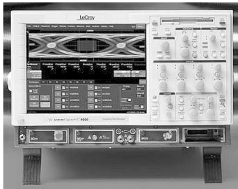
Рис. 3.36. Стробоскопический осциллограф WaveExpert фирмы LeCroy с полосой частот до 100 ГГц
