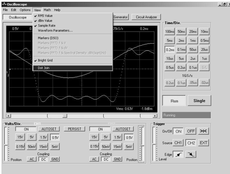
Рис. 4.21. Окно осциллографа с открытой позицией View меню и осциллограммами с точечным представлением
