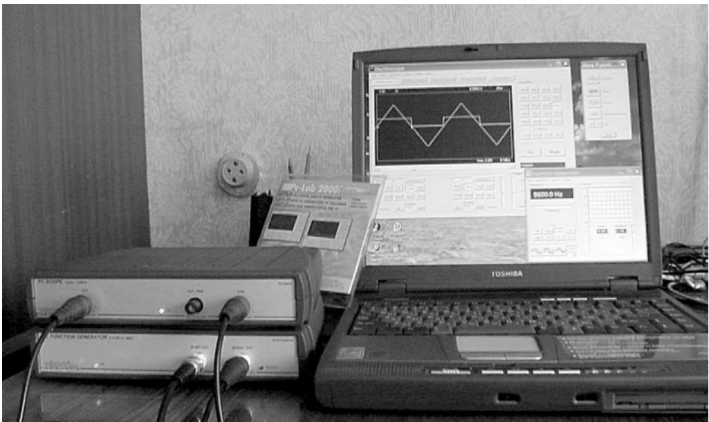
Рис. 4.13. Внешний вид компьютерной измерительной системы на базе виртуальных приборов и мобильного компьютера — ноутбука Satellite 1800-314 корпорации Toshiba
