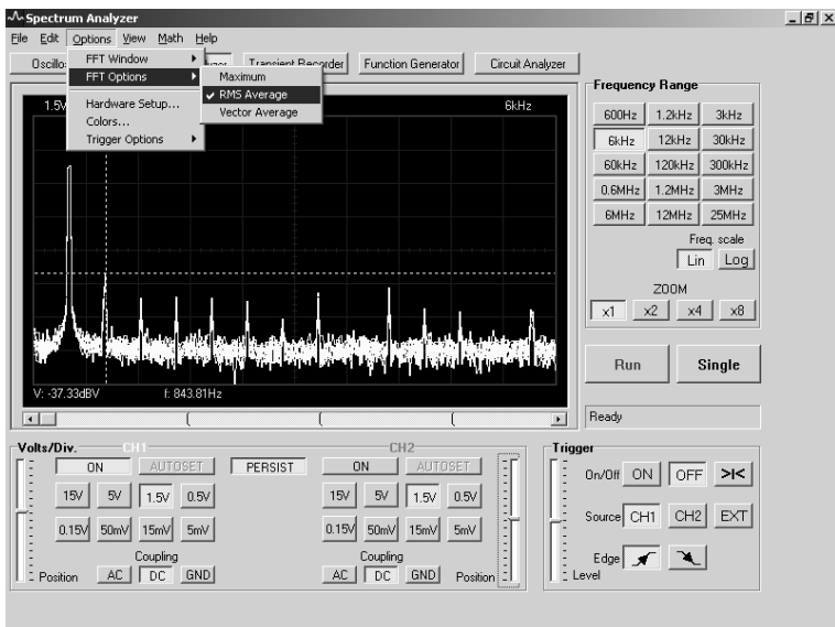
Рис. 4.25. Работа анализатора спектра в режиме запоминания спектрограмм
