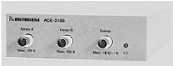
Рис. 4.41. Внешний вид двухканальной 100-мегагерцевой приставки АСК3106
