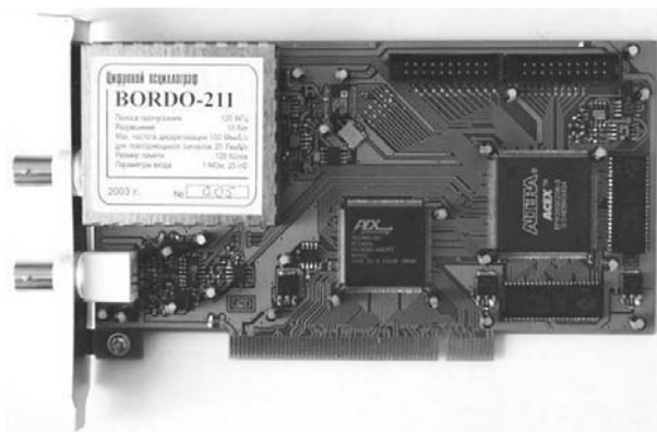
Рис. 4.31. PCI плата одноканального 120-мегагерцевого осциллографа В-211
