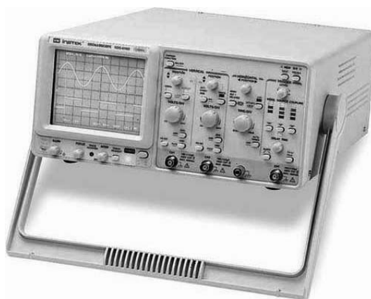
Рис. 2.18. Универсальный осциллограф GOS-635G (35 МГц)
