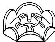
Рис. 66. Стопорение резьбового соединения пружинной контргайкой
