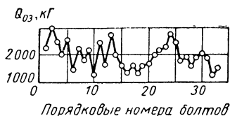
Рис. 25. Усилия затяжки в болтах \frac{5}{8} " при M_{к.а} = 800 кгсм = const
