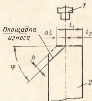
Рис. 14. Схема измерения высоты изношенного слоя алмаза:
