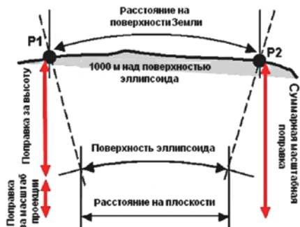
Рис. 4. Связь между суммарной масштабной поправкой и поправками за высоту и масштаб проекции.
