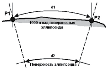
Рис. 2. Разница между расстоянием на поверхности эллипсоида и на высоте 1000 м над поверхностью эллипсоида.
