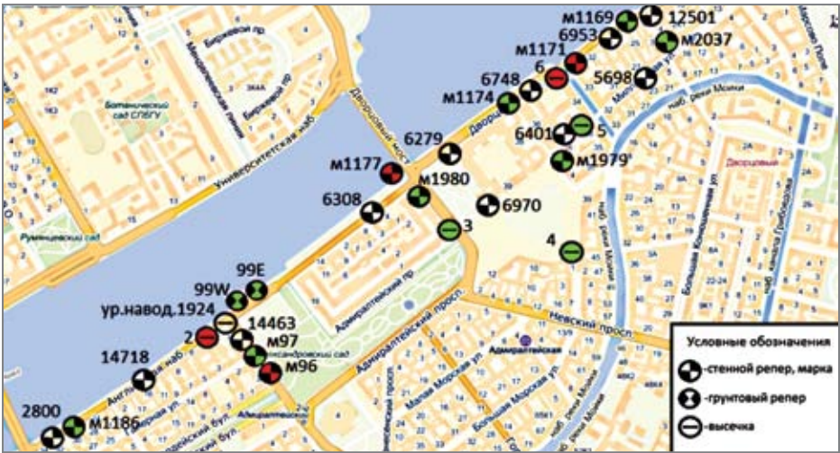
Рис. 8. Схема знаков 1872-1874 и 1877 г.г., включенных в контур опытного нивелирования летом 2013 г. (составители И.Сухарев и В.Хачатрян).
