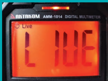
Определение фазного проводника мультиметром АММ-1014
