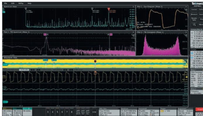
Рис. 5. Спектр пульсаций линии питания (а) и спектр TIE/джиттера (б)
