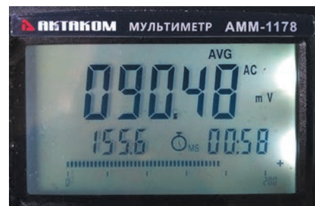
Рис. 8. Экран мультиметра АММ-1178 в режиме усреднения измеренных значений
