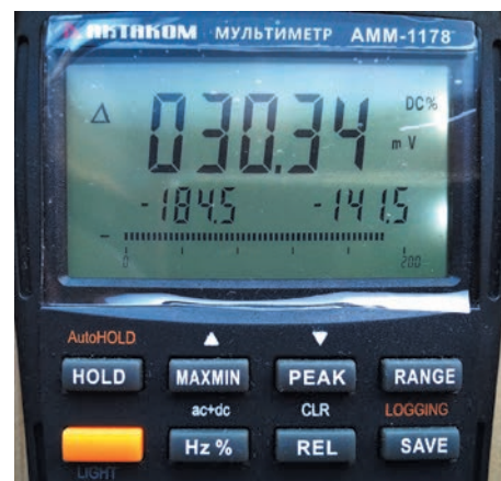
Рис. 7. Функциональные клавиши и дисплей АММ-1178 в режиме относительных измерений (значок % на экране — разность между опорным и измеренным значениями выражена в процентах)
