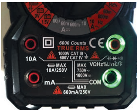
Рис. 10. Подсветка гнезд измерительных проводов мультиметра АММ-1014
