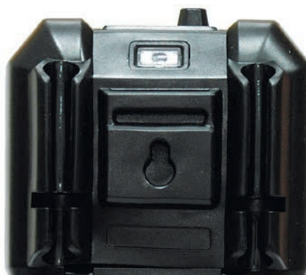
Рис. 11. Петля для ремешка, фонарик и датчик системы NCV (над фонариком)
