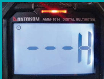
Режим бесконтактного определения напряжения у мультиметра АММ-1014
