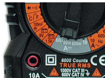
Рис. 12. Режим тестирования батарей на поворотном переключателе АММ-1014
