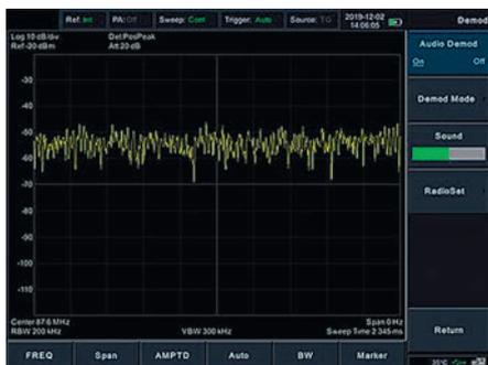
Рис. 7. Экран функции демодуляции (демодуляция аудио)
