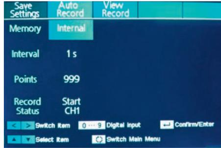
Рис. 13. Меню режима сохранения. Вкладка Auto Record установки параметров регистратора
