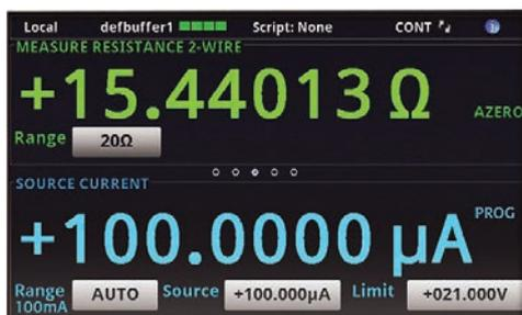
Начальная страница меню источника-измерителя содержит подробную информацию о состоянии прибора и позволяет изменять диапазоны, устанавливать выходные значения и выбирать пороги защиты, ускоряя проведение экспериментов.
