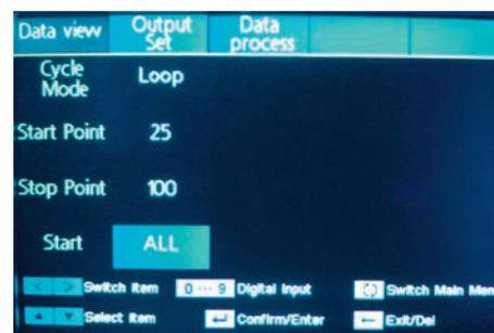
Рис. 10. Меню управления режимом работы «по списку», вкладка OutputSetup
