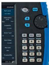
Рис. 4. Кнопочная клавиатура
