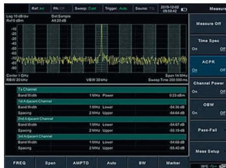
Рис. 10. Экран прибора при включенной функции измерения мощности в смежных каналах
