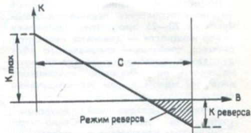
Рис. 13. К — аэродинамическое качество, В — ход клевантов, С — диапазон управления.
