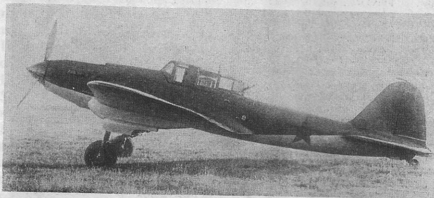
Серийный Ил-2 с турельным пулеметом УБ.
