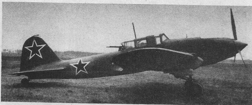
Двухместный Ил-2 со ШКАСом на турели.
