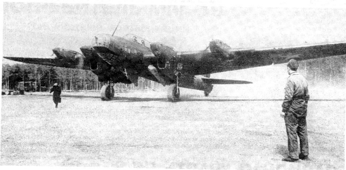
ТБ-7 с выливными авиационными приборами ВАП-500.
