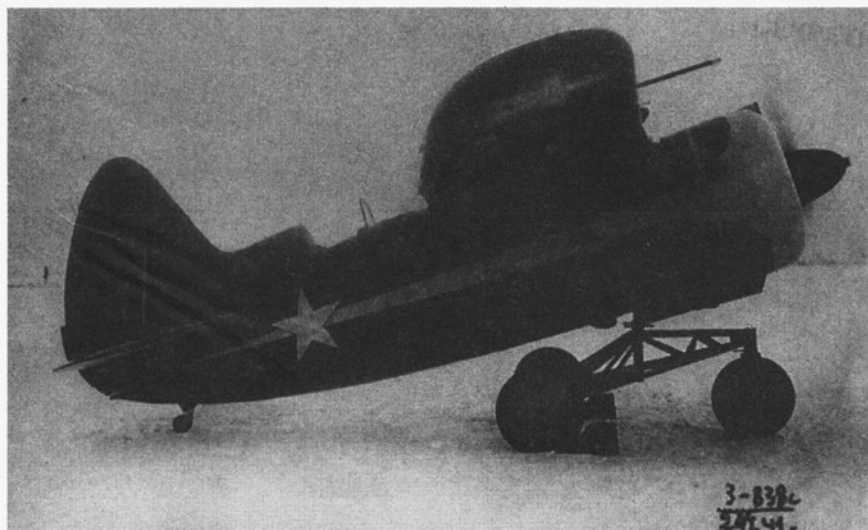
ИС-1 на транспортной тележке. Нижнее крыло убрано.
