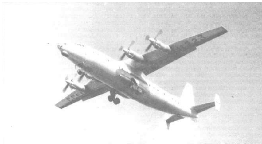
Серийный Ан-10. Видны стабилизатор с шайбами и подфюзеляжный киль. Фото С. Комиссарова
