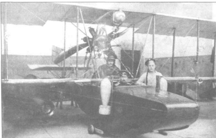
Летающая лодка «Донне-Левек» с бомбовыми подвесками. 1914 г.
