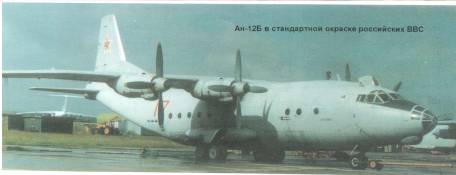
Ан-12Б МКПК "Универсал" для отработки средств десантирования
