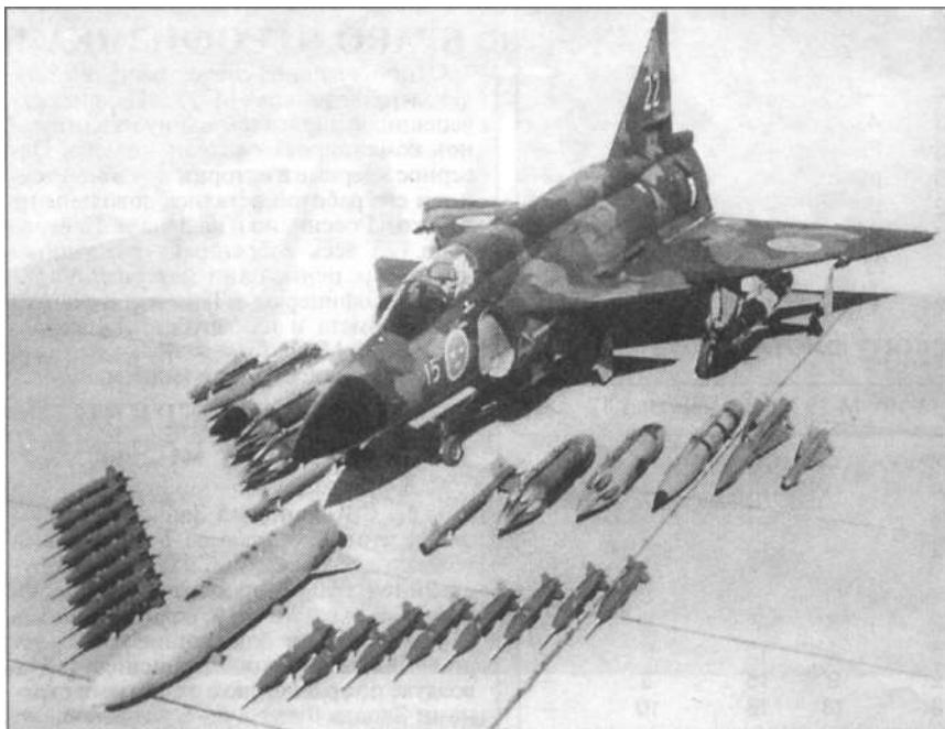
Тактический истребитель AJ37 и его вооружение.
