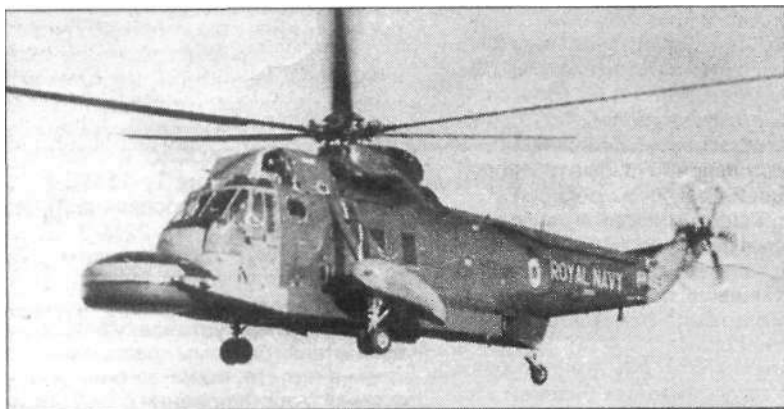
«Си Кинг» с РЛС «Блю Кестрел», предназначенной для перспективного вертолета EH.101 «Мерлин».
