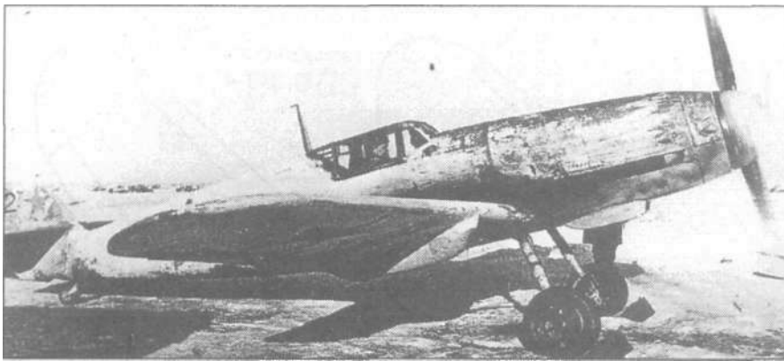
Bf 109G-2/R6, захваченный советскими войсками под Сталинградом. На самолете отсутствуют створки шасси.
