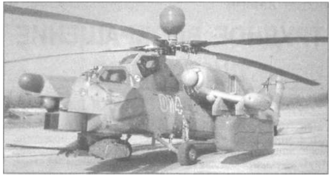
Ми-28Н на заводском аэродроме. Под левым пилоном — контейнер с измерительной аппаратурой.
