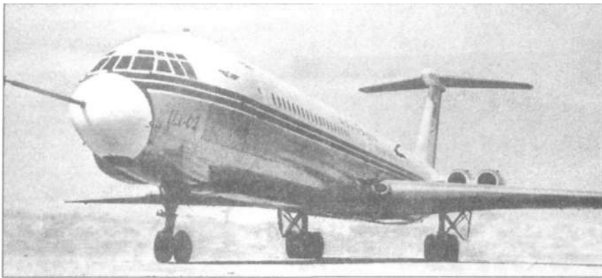
Первый прототип Ил-62 с двигателями АЛ-7П. В носу виден приемник воздушного давления (ПВД), устанавливавшийся на время летных испытаний.
