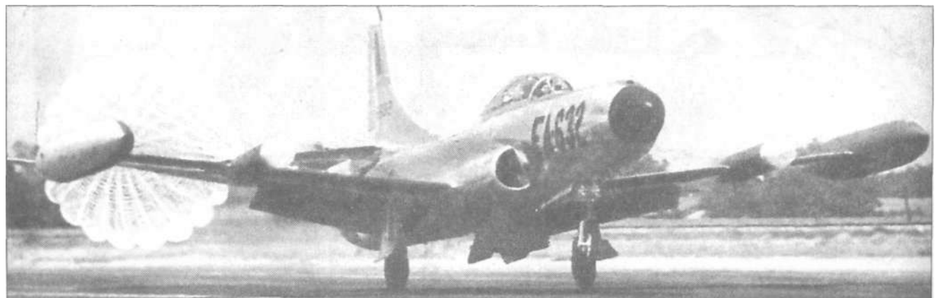
Серийный F-94C с контейнерами для ракет на консолях и топливными баками на законцовках крыла.
