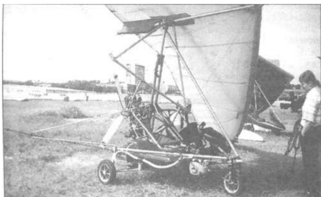
Дельталет FO-2 с компрессором для опыления.
