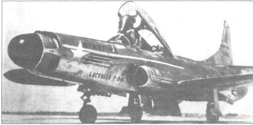
Прототип F-94C. Главные отличия этой модификации — батарея НУРСов в носу (створки открыты) и стреловидное оперение.
