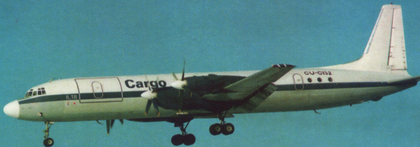
Кубинский транспортный Ил-18Гр. На левом борту видна большая грузовая дверь.
