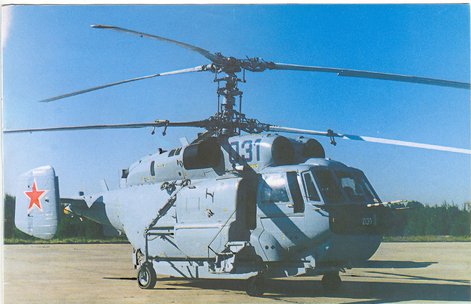
Вертолет Ка-31 с радиолокационной системой раннего обнаружения воздушных и надводных целей.
