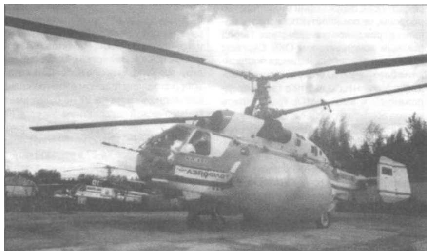
Ка-32Сс наполненными баллонетами для аварийной посадки на воду.
