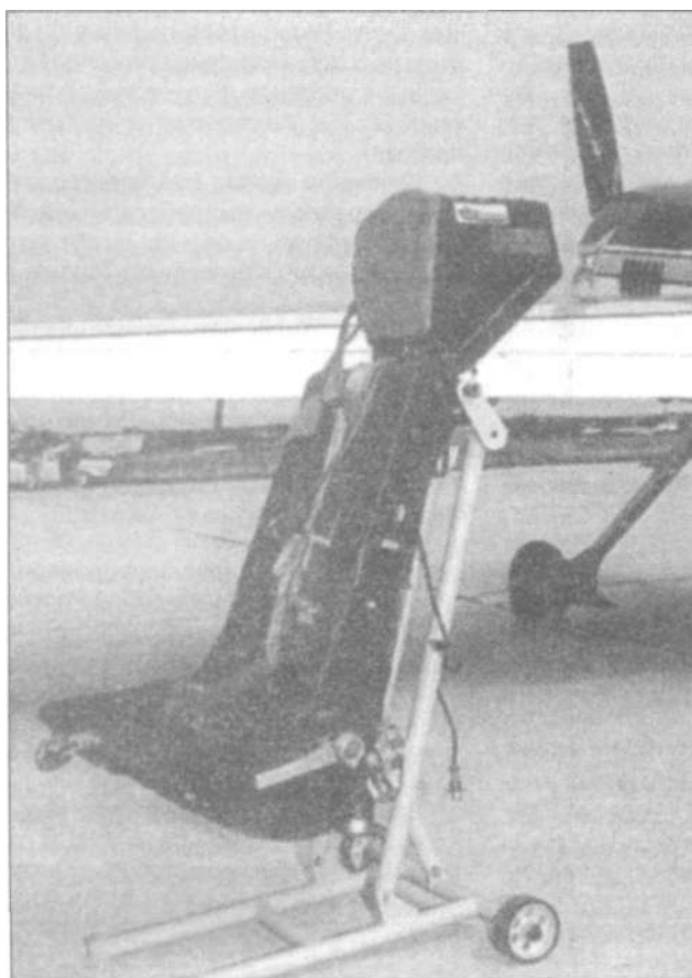
Система аварийного спасения летчика СКС-94 подготовлена к установке на самолет.
