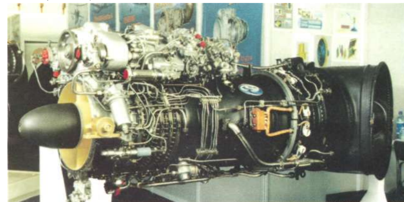
ТВЗ-117ВМА-СБМ1 ЗМКБ "Прогресс" (генеральный конструктор Ф.М.Муравченко) и ГУП "Завод им. В.Я.Климова" (генеральный конструктор А.А.Саркисов) и ВК-2500 (внизу) ГУП "Завод им. В.Я.Климова (генеральный конструктор А.А.Саркисов).
