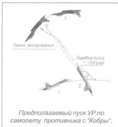
достигаются углы тангажа  $70-120^\circ$ , углы атаки  $80-95^\circ$ , скорость ввода в фигуру - 500 км/ч, а на выводе - 200-230 км/ч, что меньше эволютивной для Су-27.
