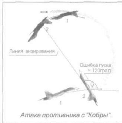
УР. Но если противник находится на значительно меньшем удалении и не имеет возможности применить ракету, то в любом случае произвести прицельную стрельбу из пушки он сможет. Замечу, вес секундного залпа пушки М61 "Вулкан" около 12 кг. К тому же для атакующего в заднюю полусферу противника, который намерен применить пушечное вооружение, нет лучшей цели, чем самолет при угле атаки 120°, т.к. не попасть в 100-150 м<sup>2</sup> сложно.
