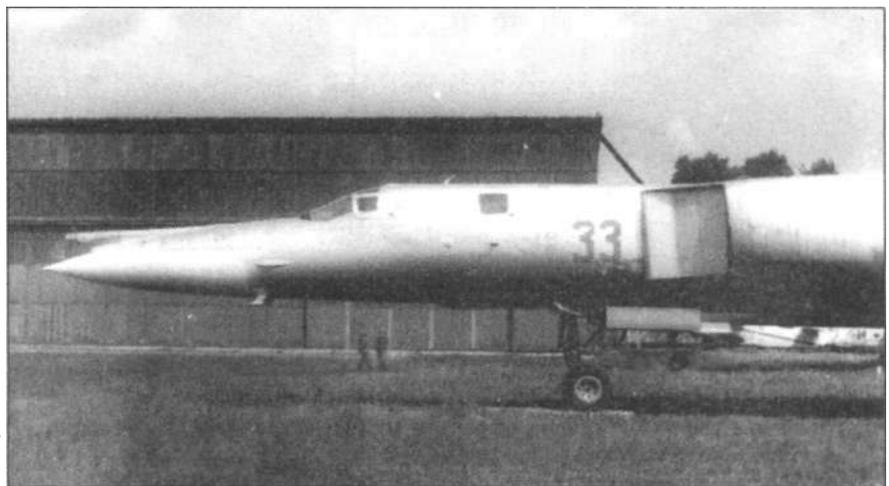
*На машинах нулевой серии установили оборудование дозаправки топливом в полете, но на серийных Ту-22М2 после заключения договора по ограничению стратегических наступательных вооружений эти устройства демонтировали. На этом Ту-22М0 штангу топливopриемника просто обрезают.*
