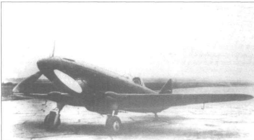
Шасси - классической для тех лет схемы с костыльным колесом. Основные одностоечные опоры с задним подкосом убирались в центроплан, а хвостовое колесо - в фюзеляжную нишу.
