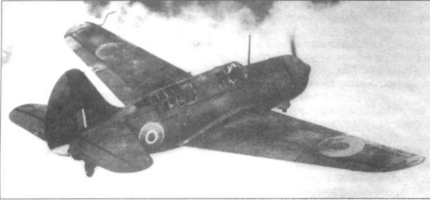
Летные данные перетяжеленного "Хеллдайвера" резко ухудшились. Ведь двигатель остался тот же, и доработанный самолет стал еще более неустойчивым и медлительным.
