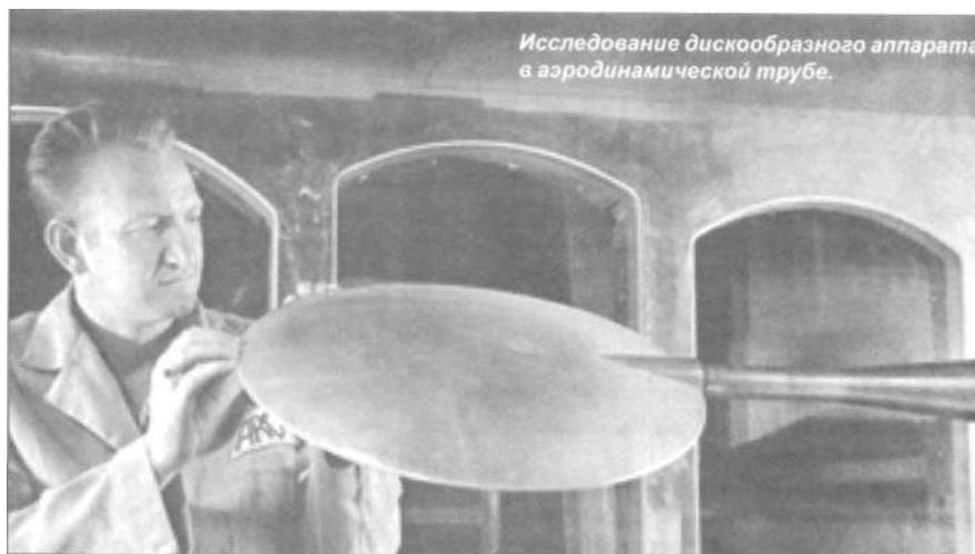
тальные исследования установили, что передняя кромка диска при спуске с орбиты нагревается примерно на 30% меньше, чем носовой обтекатель обычного аппарата полусферической или конической форм.
