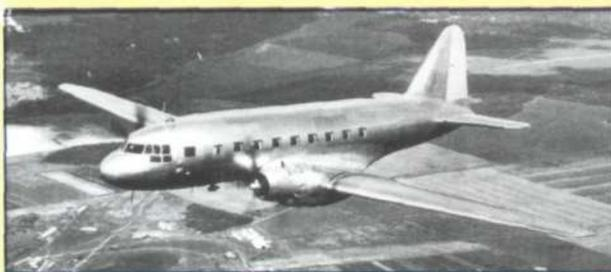
15 августа 1945 года состоялся первый полет опытного самолета Ил-12 с двумя дизельными двигателями АЧ-31. Экипаж – В. К. и К. К. Коккинаки. Несколько полетов по программе заводских испытаний выявили необходимость замены дизелей на серийные бензиновые двигатели АШ-82ФН.
