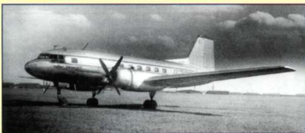
13 июля 1950 года состоялся первый полет опытного пассажирского самолета Ил-14 с двумя двигателями АШ-82ФН. Командир корабля – В. К. Коккинаки. Через два с половиной месяца состоялся первый полет модифицированного самолета Ил-14П с двигателями АШ-82Т, с новым крылом и увеличенным вертикальным оперением. 14 марта 1954 года состоялся первый полет первого серийного Ил-14П, выпущенного на Ташкентском авиационном заводе.
