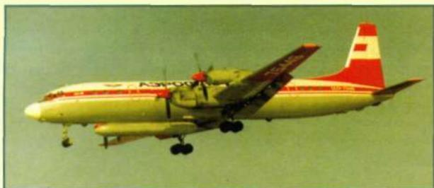
Ледовый разведчик Ил-24Н создан на базе Ил-18 и предназначен для получения информации о ледовом покрове Северного Ледовитого океана с целью обеспечения транспортного мореплавания в Арктике, а также для геологического изучения территории СССР. Работы по самолету были начаты в 1970 году.
