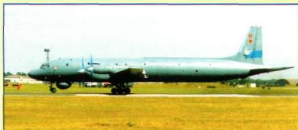
Работы по созданию дальнего противолодочного самолета Ил-38 были начаты в июне 1960 года. От Ил-18 самолет Ил-38 отличается новой конструкцией фюзеляжа и сдвинутым на три метра вперед крылом. Носовая часть с кабиной экипажа герметизирована. В переднем и заднем грузотсеках размещалась боевая нагрузка: радиогидроакустические буи различных типов, бомбы, мины и специально созданные для Ил-38 авиационные торпеды АТ-2.
