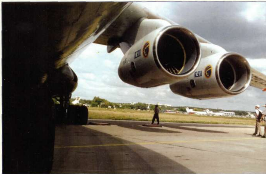
Двигатели ПС-90А-76 на крыле самолета Ил-76МФ
