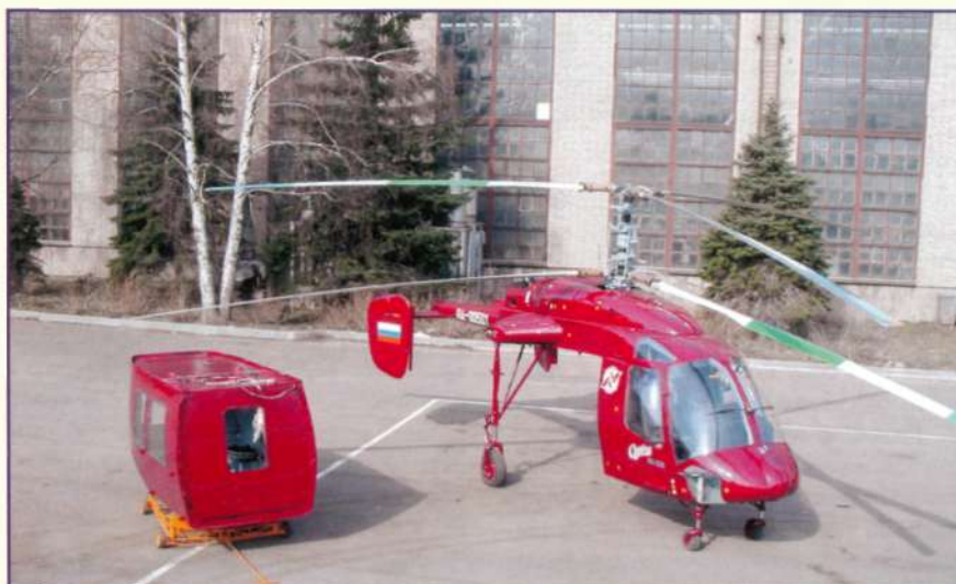
Планер вертолета – модульной конструкции
