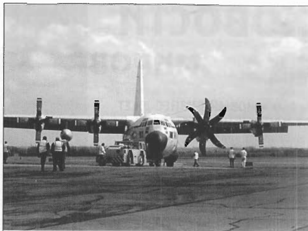
Летающий стенд С-130К с двигателем TP400-D6
