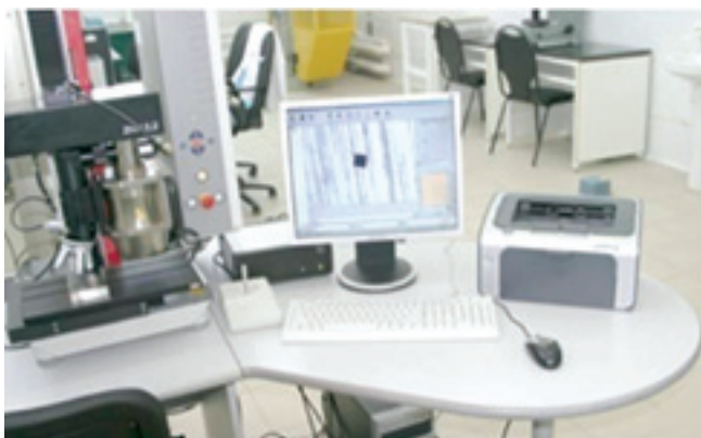
Универсальная машина Zwick 'ZO,2 для измерения твердости материалов по Виккерсу, Роквеллу,Бринеллю, Клуппу, Мартенсу.
