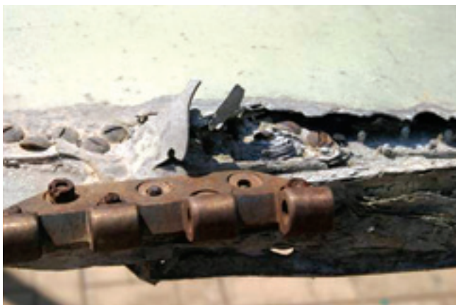
Фрагмент закрылка А40 (25 лет испытаний)
