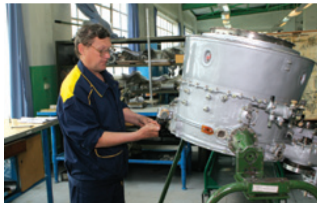
Участок ремонта коробок двигательных аппаратов
