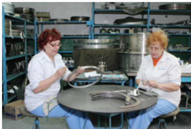
Участок ремонта спрямляющих аппаратов
