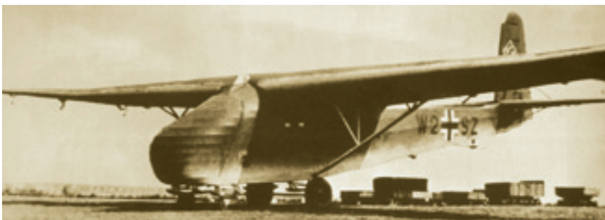
Планер Me 321A1. Планер установлен на колёсное шасси. Обратите внимание на маленькую, по сравнению с фюзеляжем, кабину пилота. Первый дивизион транспортных планеров, июнь 1941 г.
