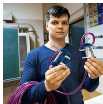
Рис. 3. Трубка заполнена подкрашенной водой, концы зажаты струбцинами
