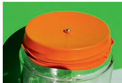
Из-за разности давлений плёнка принимает сферическую форму
