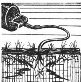
ности. Катодом в эксперименте служила 8-метровая обсадная перфорированная труба, а анодом — соединенные железными прутками газовые трубы, расположенные по трем сторонам участка через 5 метров один от другого и забитые на глубину 1,6—1,8 метра. Напряжение 44 вольта подавали от сварочного трансформатора. Через неделю анализ почвенной влаги показал снижение солей в метровой толще на 23,7 процента.
