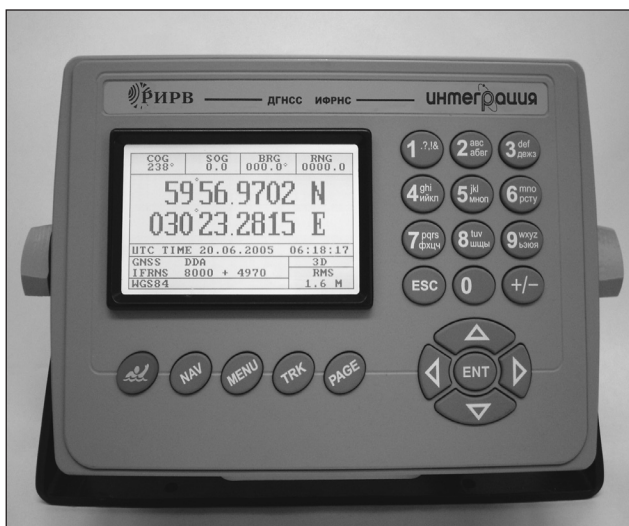
Рис. 1. Внешний вид интегрированной аппаратуры ГЛОНАСС/GPS/«Лоран-С»/ «Чайка»
