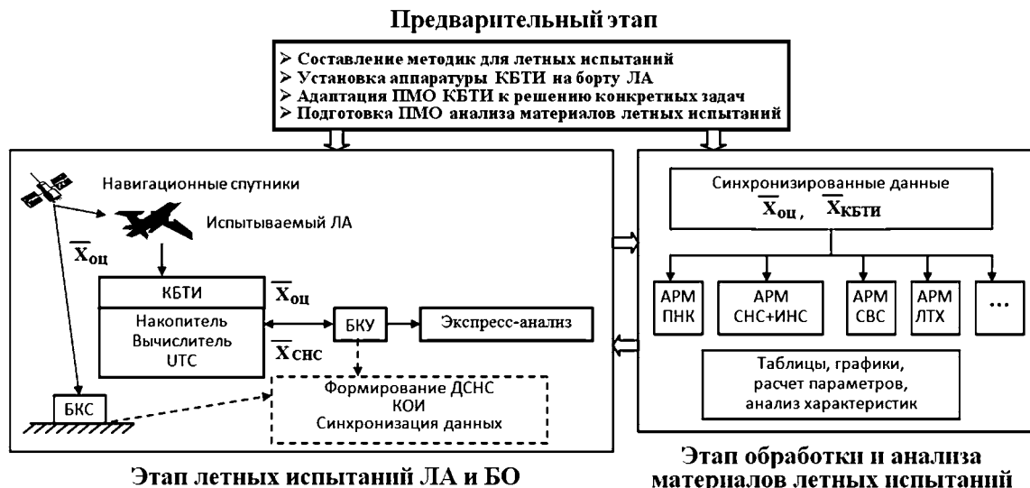
Рис. 2. Технологический цикл испытаний и обработки ПНО, в том числе ИНС, СНС, ИСНС, с применением КБТИ
