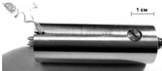
Собранный в ФИАНе прототип квантового дискриминатора объемом 10\text{ см}^3
