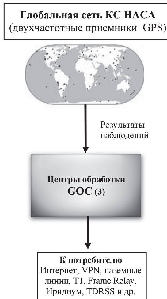
Рис. 1.2. Структурная схема GPS
