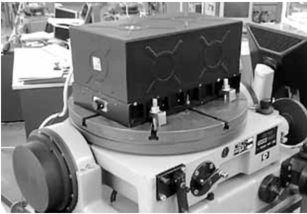
Рис. 1. Общий вид БЧЭ с сервисной электроникой, установленного на поворотном столе
