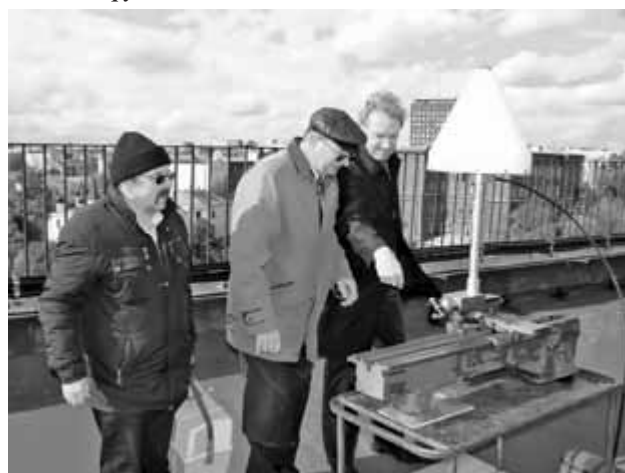
Рис. 3. УЭПА на основе суппорта металлообрабатывающего станка
