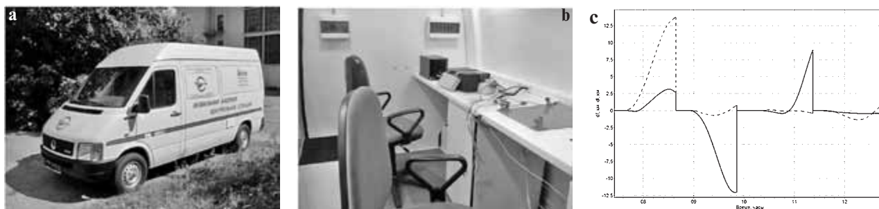
а) внешний вид МБКС; б) размещение испытываемого бортового оборудования в операторском отсеке МБКС; в) погрешности координат испытываемой ИСНС в динамическом режиме.
