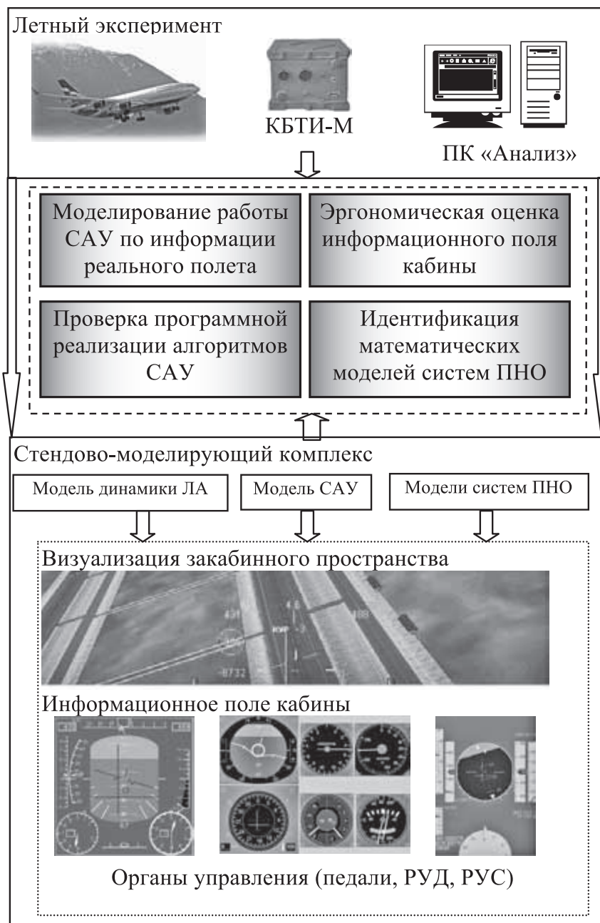
Рис. 6. Технология испытаний и оценки системы автоматического управления
