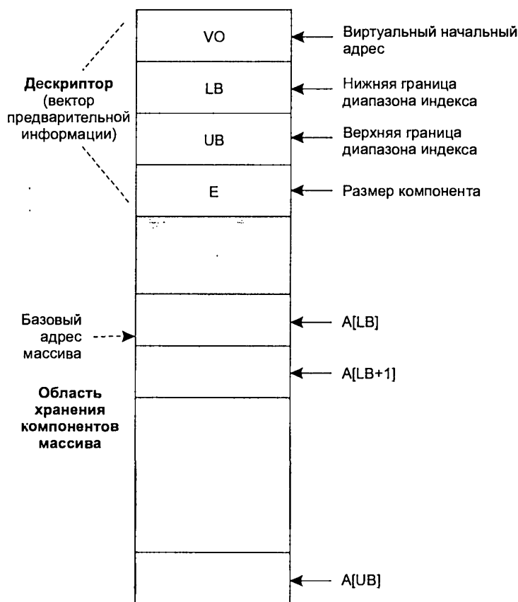
Рис. 6.4. Несмежные области хранения дескриптора и компонентов массива
