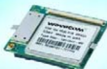
Серия GS64 ARM9, TCP/IP GSM /GPRS кл.10 SIM-держатель малые габариты
