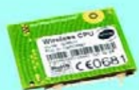
Серия Q2687H ARM9, Open AT GSM /GPRS/EDGE 10 класс, TCP/IP 32 M6 Flash
