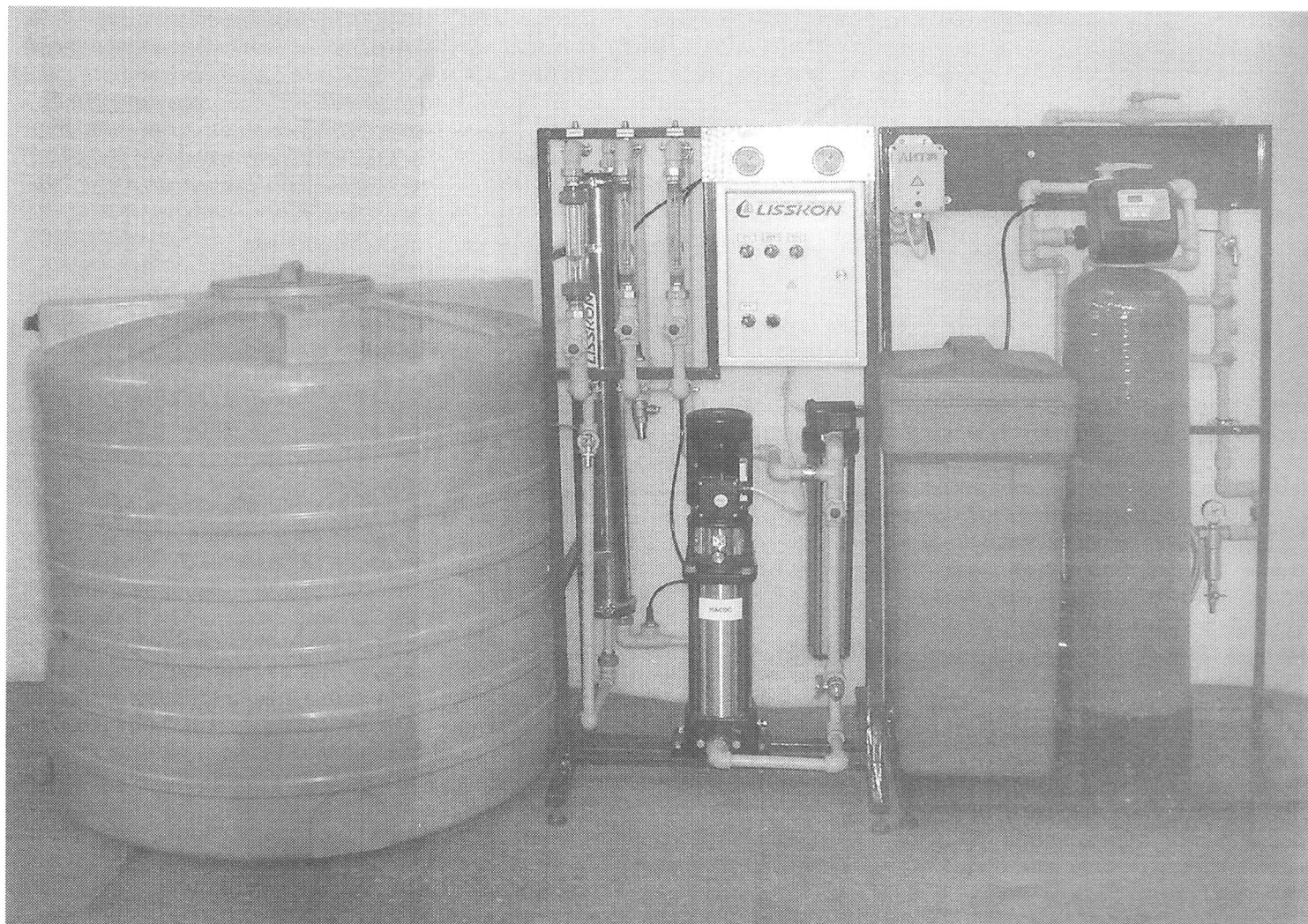
Лисскон-101-10 - система локальной очистки питьевой воды
