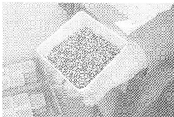
Эти, на первый взгляд, невзрачные гранулы являются микроэлектродвигателями, используемыми для управления спидометра и других инструментов приборной панели
