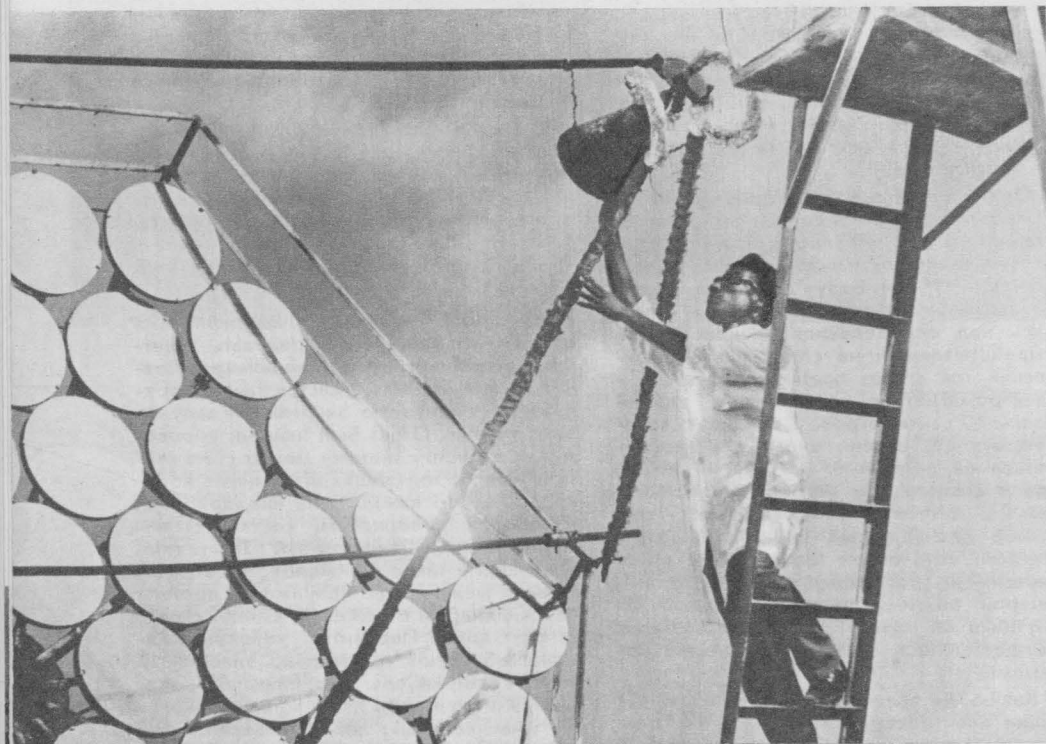
В фокусе этого факеточного концентратора температура составляет около 2 тысяч градусов.
