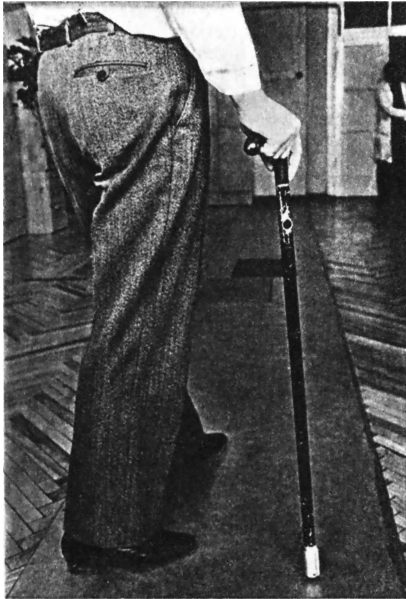
Палка-трость с вмонтированным в нее датчиком позволяет судить о нагрузке больной ноги.
