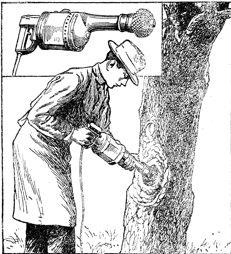
Прибор для чистки ран на деревьях. Вверху — вид прибора отдельно; виден полушаровый скребок.
