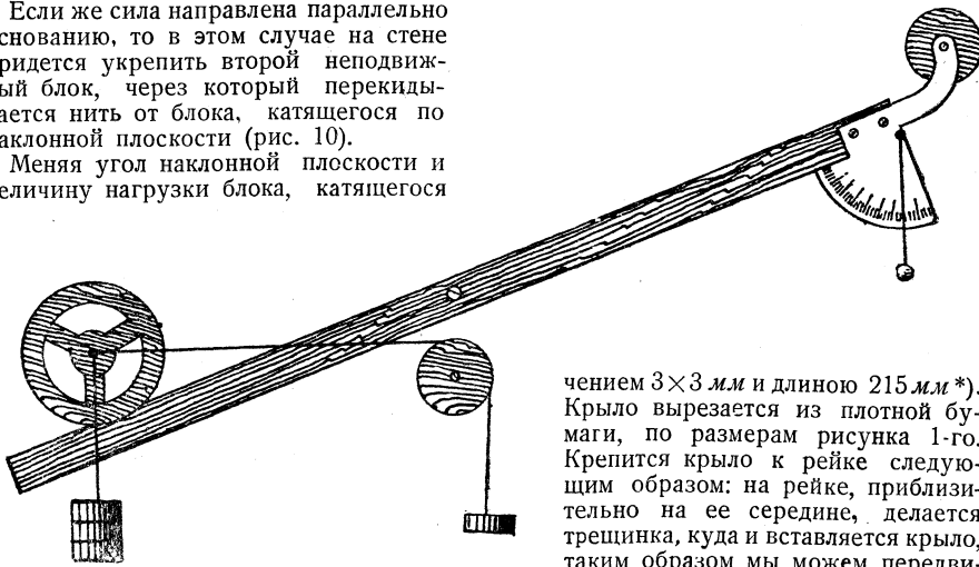
Рис. 10. Наклонная плоскость. Груз удерживается силой параллельной основанию плоскости.
